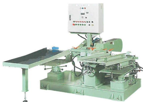
エンドレスベルト型 自動供給・排出装置付き
